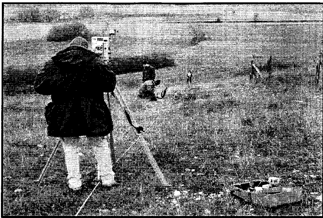
Foto 3: esecuzione della tomografia elettrica n. 3 e della campagna topografica d'appoggio.
